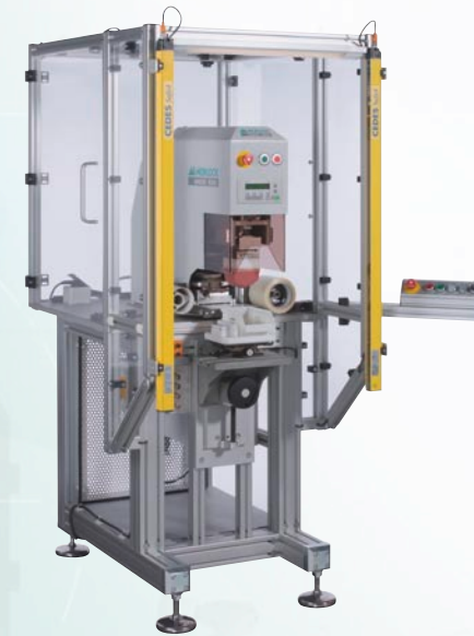
MDX 100 auf Maschinengestell mit Schutzumhausung und Lichtschranke
